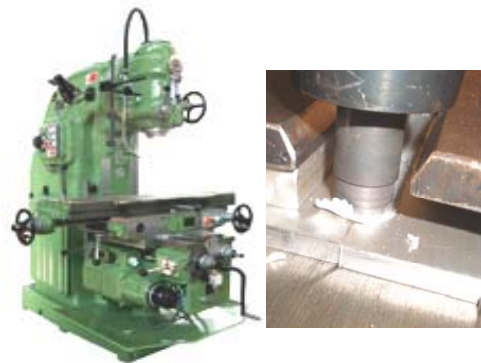
รูปที่ 3 เครื่องมือกัดโลหะแกนตั้งและการเชื่อมชิ้นงานแบบต่อชน
